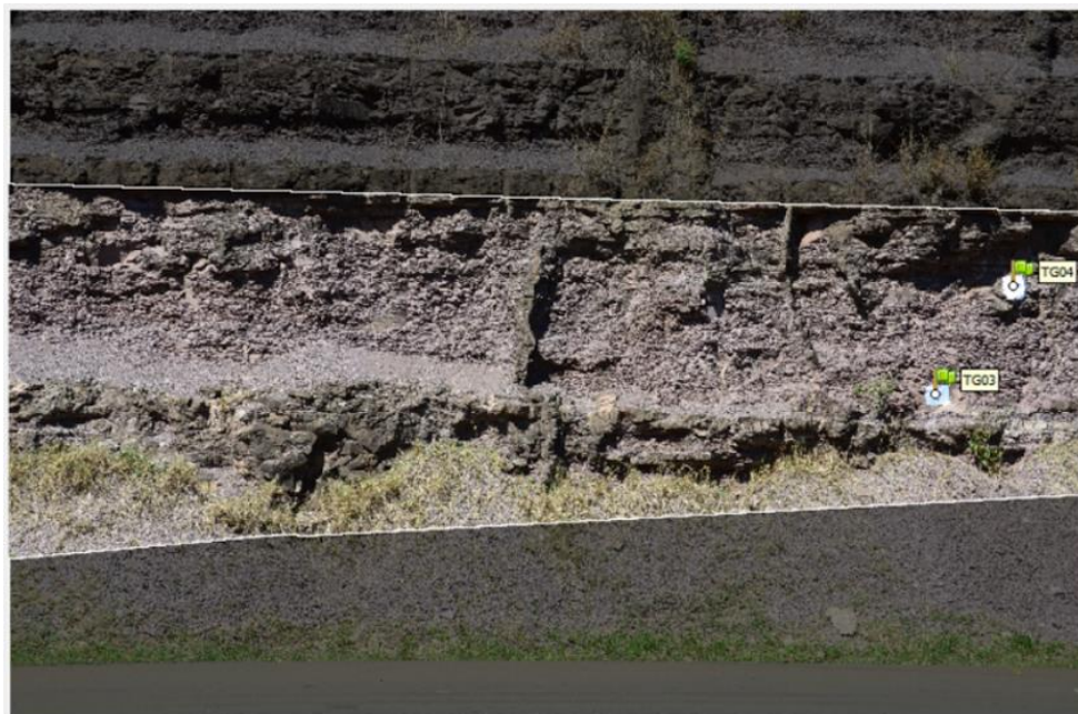
Figura 08. Demonstração do funcionamento da função Mask no Agisoft Photoscan, as áreas da foto cobertas em cinza não serão processadas. As bandeiras verdes indicam o centro dos alvos (TG03 e TG04) identificados no software para auxiliar o georreferenciamento através da função Create Marker .
