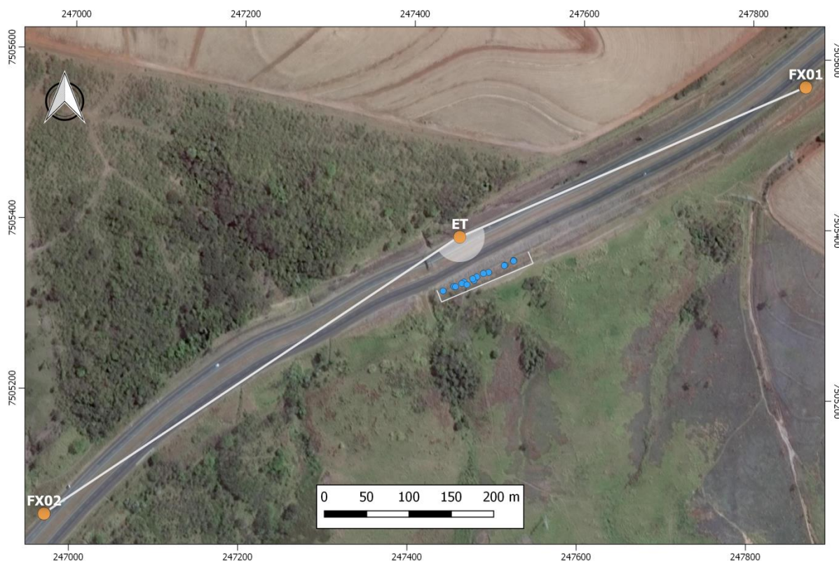
Figura 06. Posicionamento da estação total (ET), os pontos fixos (FX01 e FX02) e os alvos distribuídos no afloramento (em azul) em relação à rodovia BR-183, obtidos com as coordenadas do dGPS. Em destaque, o ângulo horizontal de abertura de um ponto fixo ao outro.
